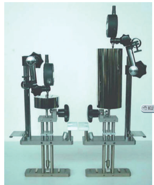
Bild 2. Einstellung des Stativs für Methode A (10 N) und Methode B (50 N). Prüfvorrichtung mit eingespannten Thermoplast-Proben im unteren Bildbereich, Seitenansicht
