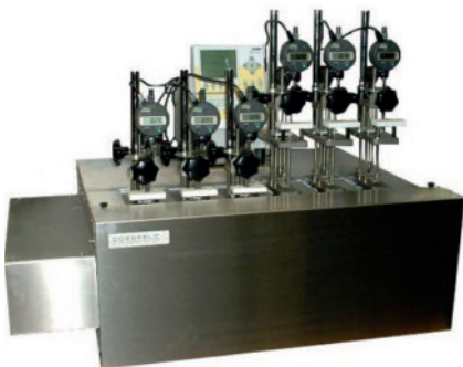
Bild 1. Basic Vicat/HDT-System mit sechs Prüfstationen und digitalen Messstellen. Ein digitaler Thermostat sorgt für präzise Prüftemperaturen im Badmedium
