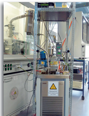
Bild 2: Messaufbau zur dynamischen Bestimmung von Dampfdrücken. Die Messzelle befindet sich im Temperierbad des Thermostaten. Weitere Komponenten sind: Druckaufnehmer, Rührwerke, Vakuumpumpenstand mit Drehschieber- und Turbopumpe.
