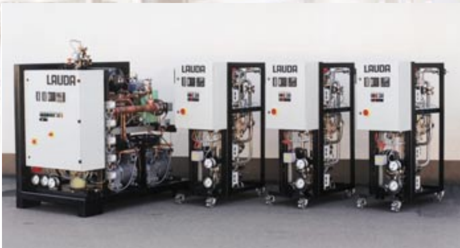
Abb. 1 Eine Prozesskühlanlage Typ SUK 350 W versorgt 3 Sekundärkreiseinheiten Typ TR 400 HK mit Tiefkühlung. Temperaturbereich -50... +200 °C, drei Reaktoren, 160 l
