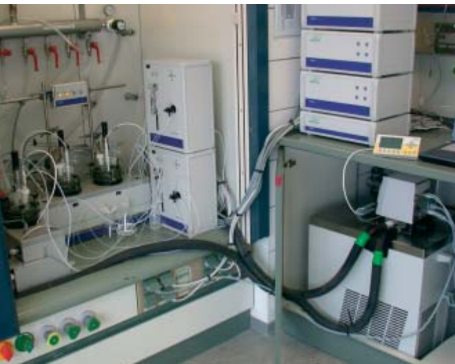
Gesamtsystem Syntheseautomat mit angeschlossenem Kältethermostaten LAUDA Proline RP 855.
