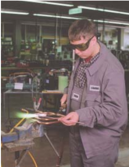
Der Kälteanlagenbauer lernt das Lötten von Kupferrohren.
