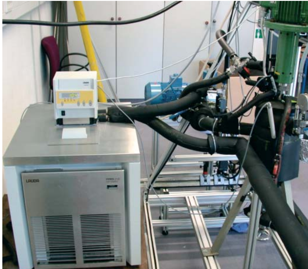
Anschluss des LAUDA Proline RP 890 C an das Reaktorsystem.
